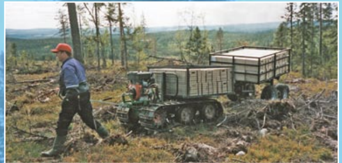
Oxen har visat sig mycket lämplig för transport av plantor. Här med ett lådställ.
